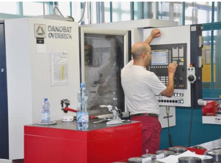
*Danobat-Overbeck IRD 400 è una rettificata per interni ad alta precisione che consente di lavorare pezzi di diametro massimo 340 mm e diametro foro 200 mm (lunghezza foro 190-380 mm)*
